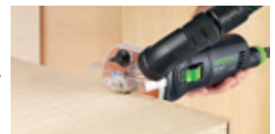
Подравняващо фрезоване на кантове от пластмаса и масивно дърво.
