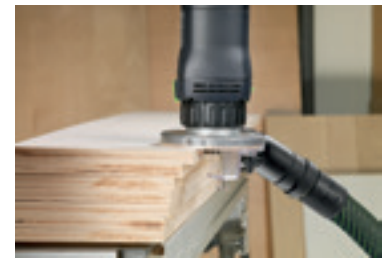
Фрезоване на фаска на кантове от пластмаса и масивно дърво.
