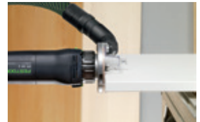
Заобляне на кантове от пластмаса и масивно дърво.
